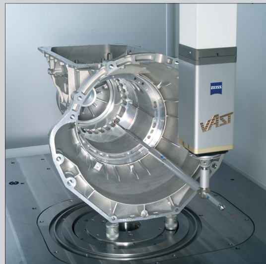
Rys. 2. Aktywna centralna głowica pomiarowa ZEISS VAST gold: maks. masa końcówek 600 g, maks. długość 800 mm
