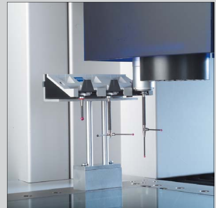
Rys. 5. System automatycznej wymiany końcówek dotykowej głowicy skanującej VAST® XXT
