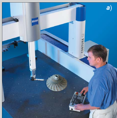
Rys. 2. Współrzędnościowa maszyna pomiarowa CONTURA ® G2 RDS z systemem MPS (a) i dotykową głowicą skanującą VAST ® XXT (b)
