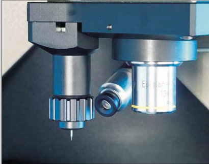
Rys. 5. Sensory pomiarowe: dotykowy ze wspomaganiami optycznymi oraz sensor optyczny ViScan Carl Zeiss
