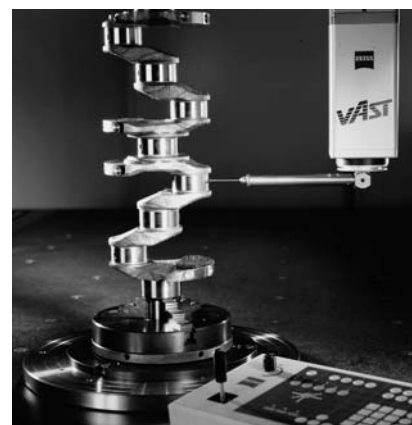
Rys. 6. Pomiar wału korbowego głowicą skaningową VAST
