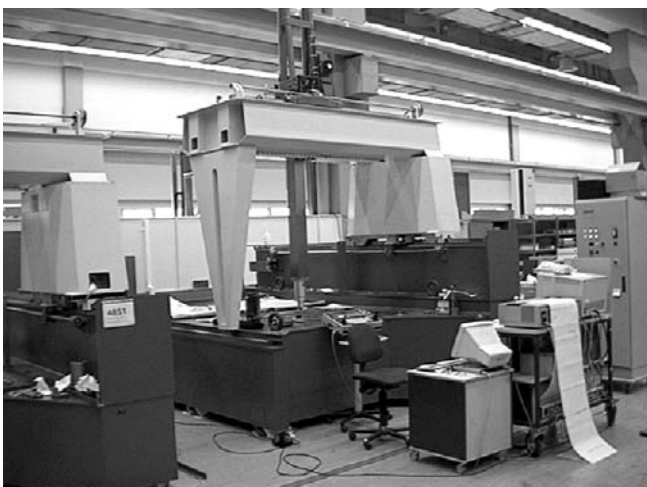
Rys. 3. Konstrukcja stalowa maszyny MMZ
