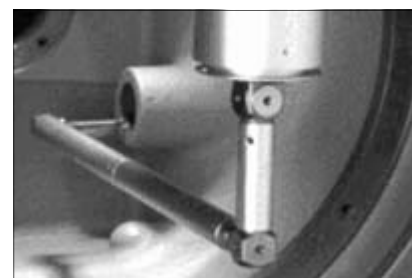
Rys. 7. Przykład skomplikowanej kombinacji końcówek pomiarowych głowicy skaningowej
