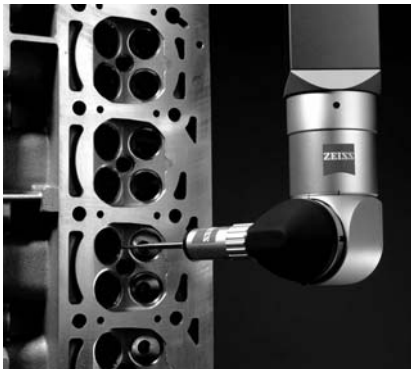
Rys. 8. Pomiar korpusu za pomocą przegubu RDS
