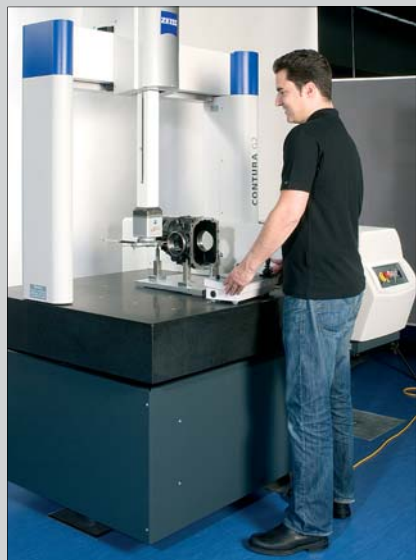
Rys. 1. Nowa skanująca maszyna pomiarowa produkcji Carl Zeiss: CONTURA G2 navigator przeznaczona do bardzo szybkich i precyzyjnych pomiarów
