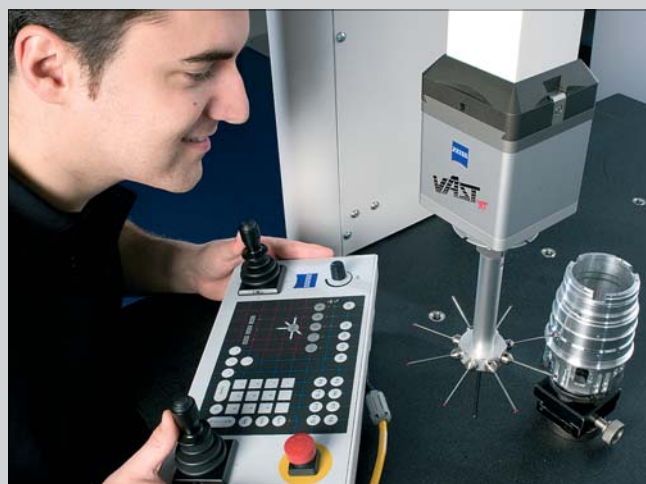
Rys. 2. Skanująca głowica pomiarowa klasy High Speed – VAST XT gold może być użyta praktycznie do każdego zadania pomiarowego, zapewniając optymalną dokładność i wydajność – pomiary kształtu i położenia, krzywych 2D i 3D oraz powierzchni krzywokreślnych 3D, a także Reverse Engineering
